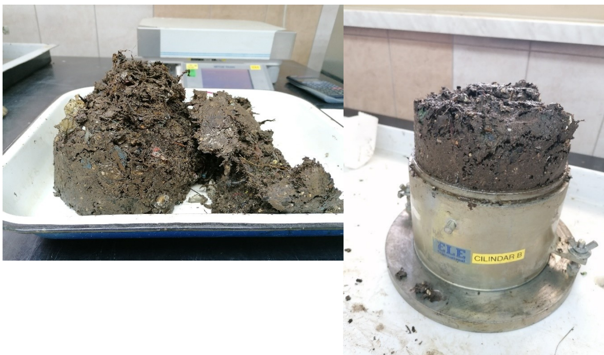
Slika 16 Zbijeni uzorak s 100% vlage (lijevo) i zbijeni uzorak s 120% vlage (desno)
