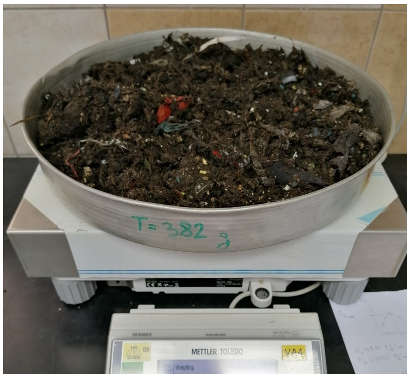
Slika 13 Vaganje zbijenog uzorka
