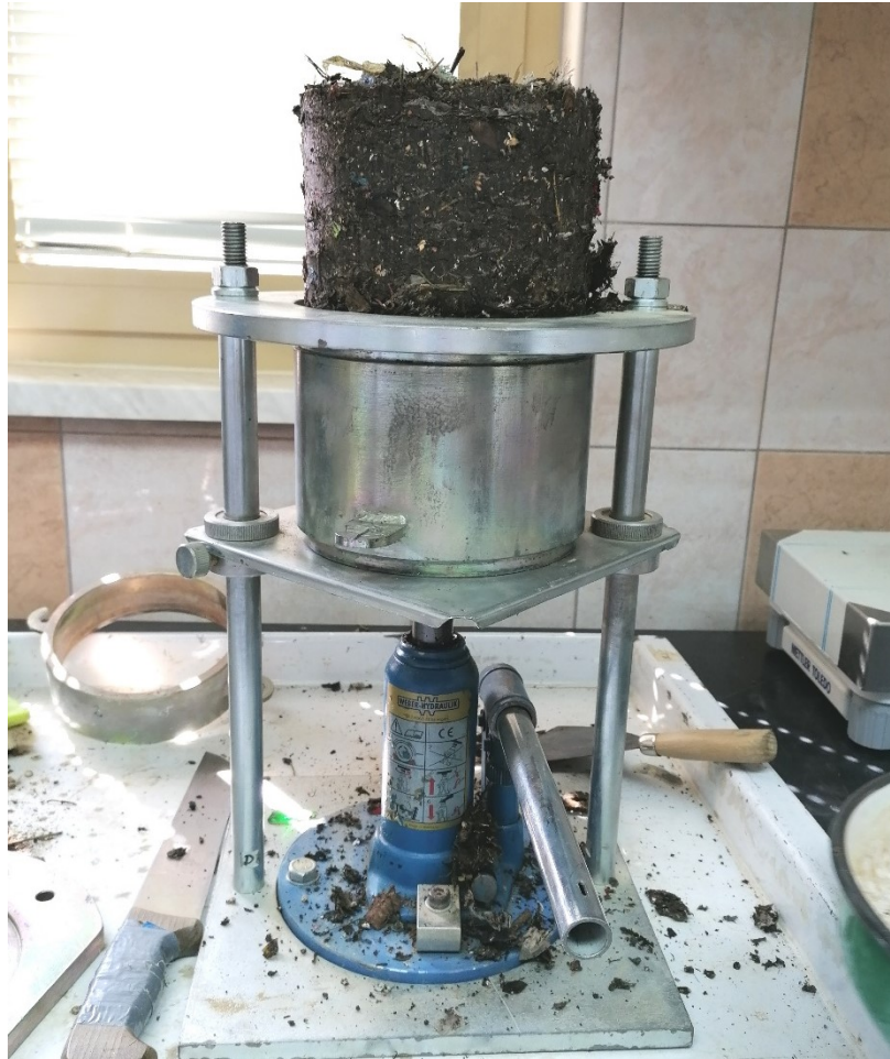
Slika 12 Vađenje zbijenog uzorka iz cilindra pomoću hidrauličke preše
