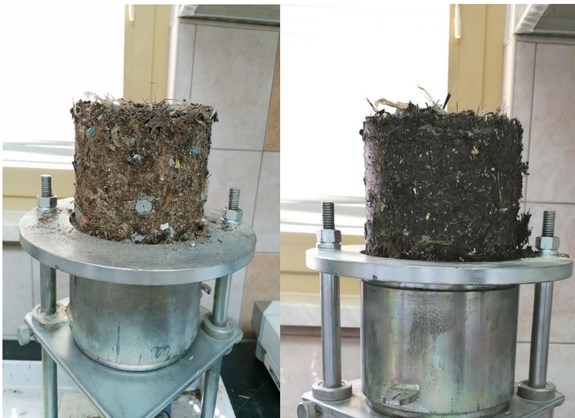
Slika 14 Zbijeni uzorak s 20% vlage (lijevo) i zbijeni uzorak s 40% vlage (desno)
