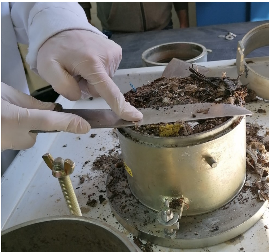
Slika 11 Poravnavanje zbijenog uzorka sa rubom cilindra
