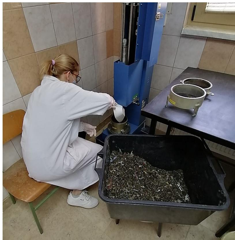
*Slika 10 Nasipavanje materijala u cilindar*
