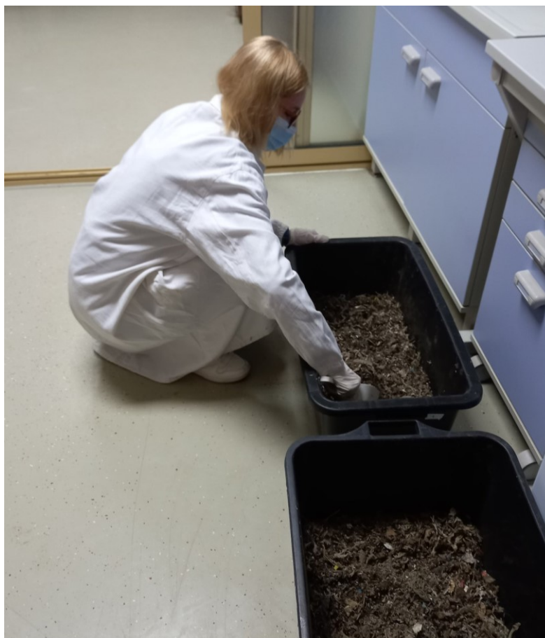
Slika 8 Miješanje suhog uzorka s vodom
