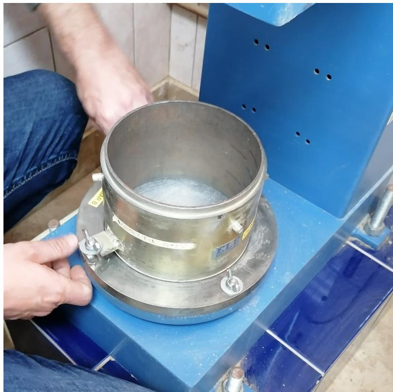
*Slika 9 Postavljanje cilindra na uređaj*
