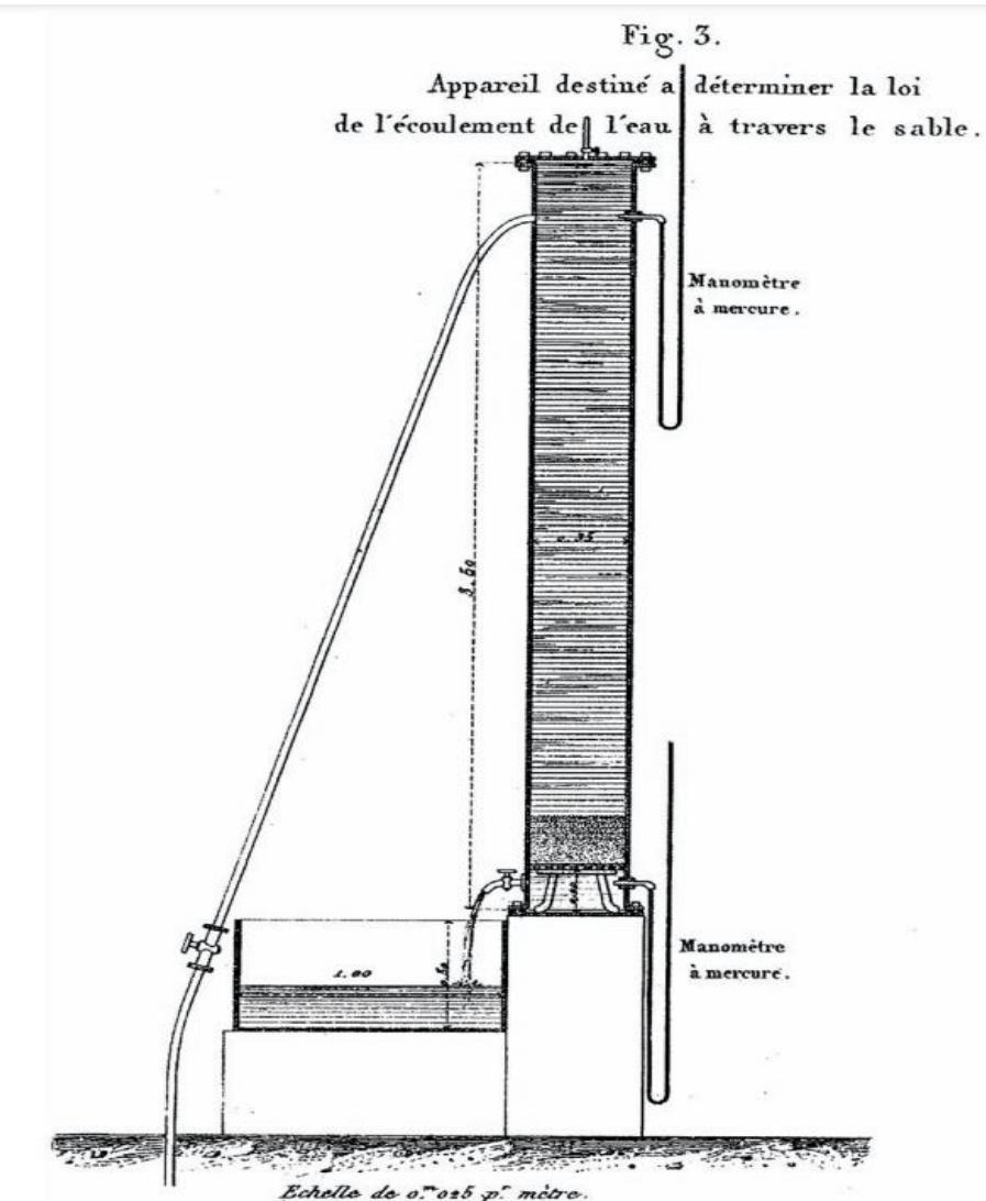
Slika 6. Shematski prikaz Darcyevog eksperimentalnog aparata [3].
