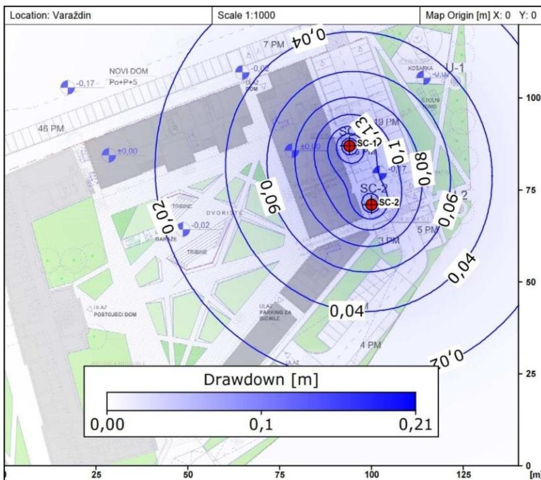
Slika 29. Utjecaj crpljenja istražno-eksploracijskih zdenaca SC-1 i SC-2 maksimalnom projektiranom crpnom količinom na sniženje razine podzemne vode.
