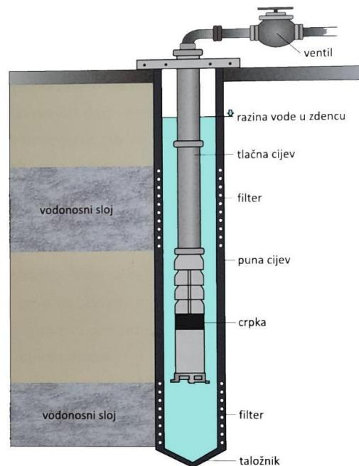
Slika 10. Shematski prikaz osnovnih komponenata zdenca [5].
