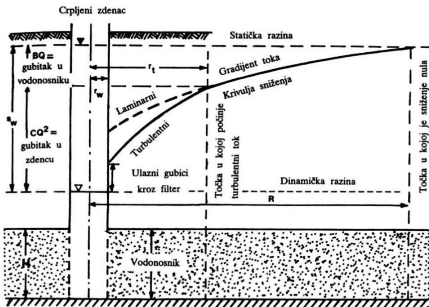
Slika 15. Shematski prikaz sniženja u crpljenom zdencu.
