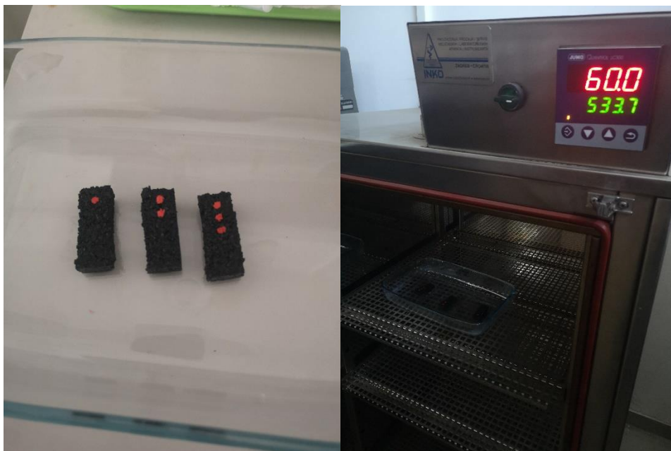
Slika 5. Gumene podloge u staklenoj ladici (lijevo) i gumene podloge u sušioniku (desno)
