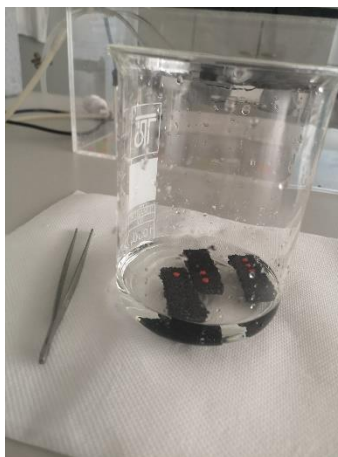
Slika 4. Prikaz umakanja gumenih podloga u otopinu NaOH
