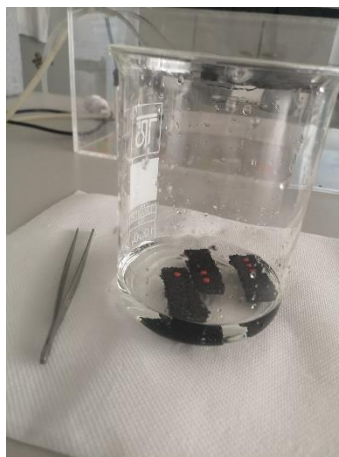
Slika 4. Prikaz umakanja gumenih podloga u otopinu NaOH
