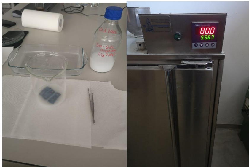
Slika 9. Umakanje gumenih podloga u pripremljenoj sol-gel otopini (lijevo) i prikaz sušionika zagrijanog na potrebnu temperaturu za sušenje gumenih podloga (desno)
