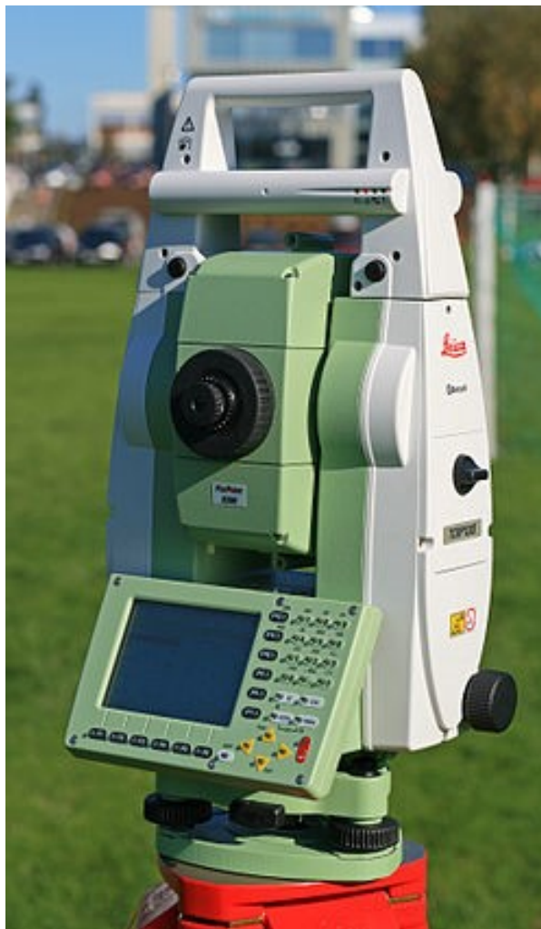
Slika 1. Mjerna stanica Leica Viva TS16 [10]
