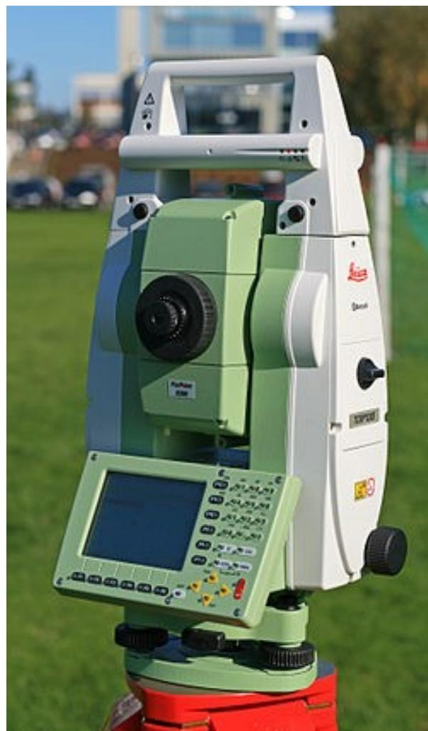
Slika 1. Mjerna stanica Leica Viva TS16 [10]
