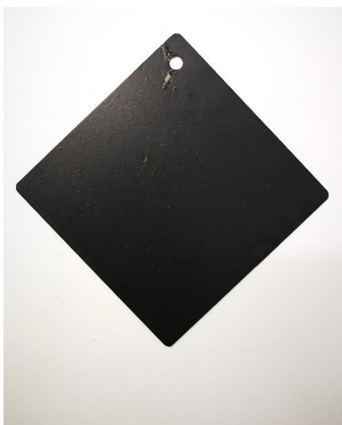
Slika 40. Pločica premazana destilacijskim muljem FP1-210205-2 bez prethodne nadorade dodatkom bitumena
