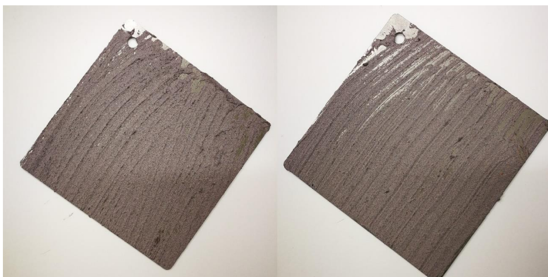
Slika 30. Pločica premazana destilacijskim muljem FP3-210202-2 u koji je dodano 5% regenerata
