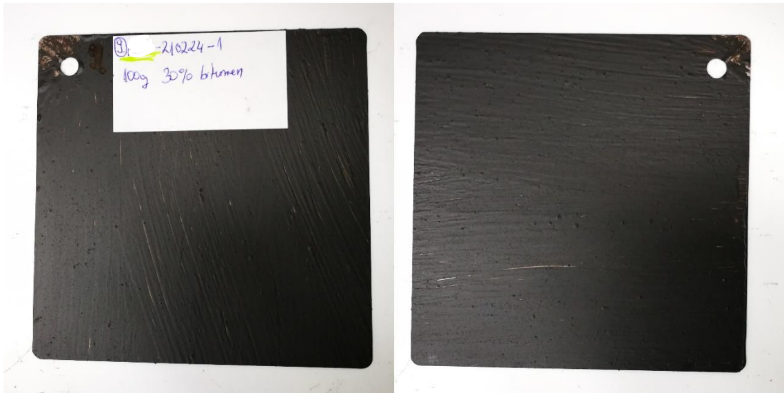
Slika 47. Pločica premazana destilacijskim muljem FP2-210224-1 s dodatkom 30% bitumena
