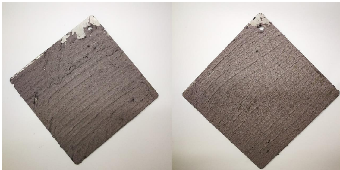
Slika 31. Pločica premazana destilacijskim muljem FP3-210202-2 u koji je dodano 10% regenerata
