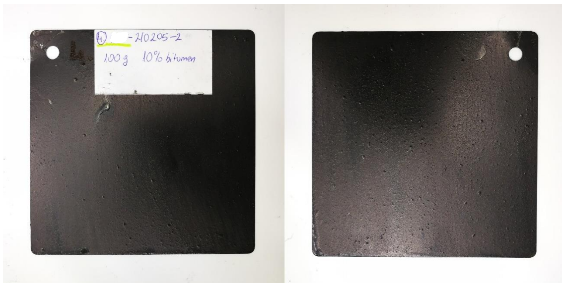
Slika 41. Pločica premazana destilacijskim muljem FP1-210205-2 s dodatkom 10% bitumena
