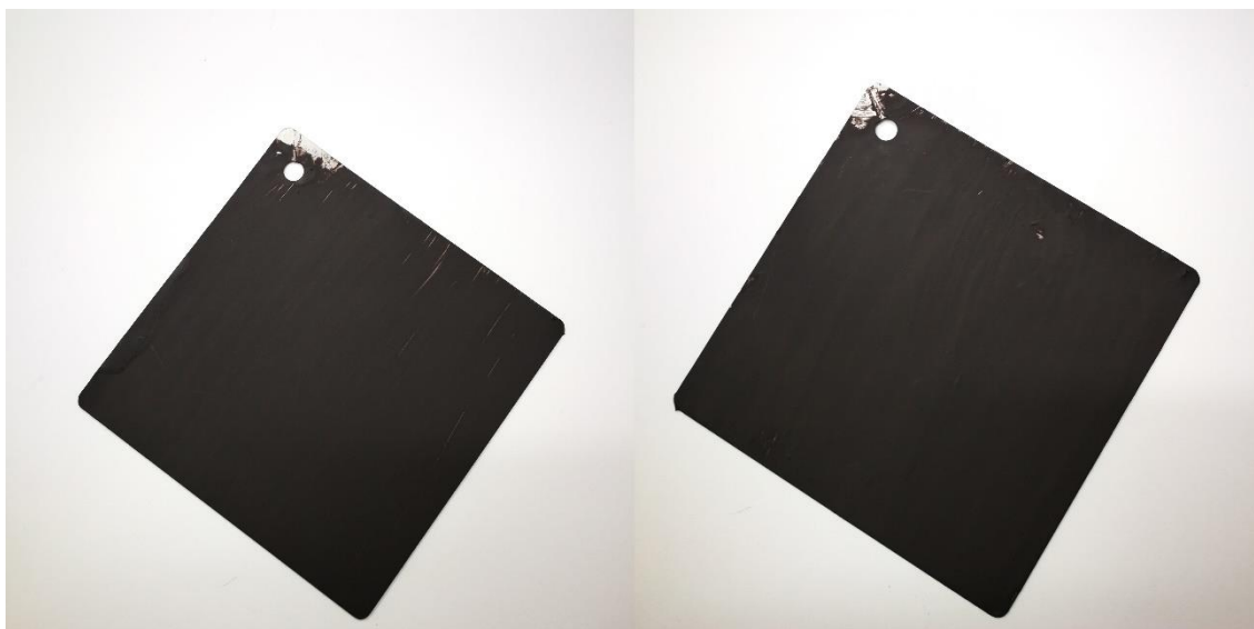
Slika 28. Pločica premazana destilacijskim muljem FP3-210202-1 u koji je dodano 10% regenerata
