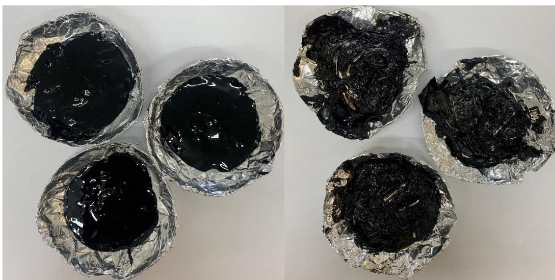
Slika 20. Prije i nakon sušenja uzorka Mipa Underbody Coating
