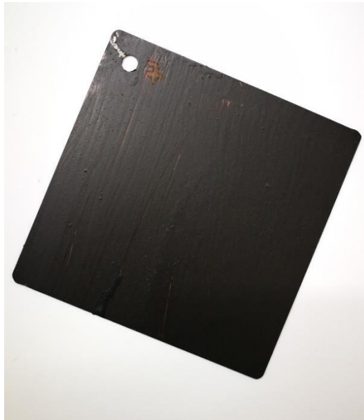
Slika 44. Pločica premazana destilacijskim muljem FP2-210214-1 bez prethodne nadorade dodatkom bitumena
