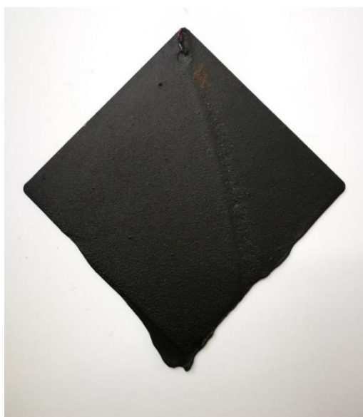
Slika 26. Pločica premazana destilacijskim muljem FP3 -210202-1 bez nadorade
