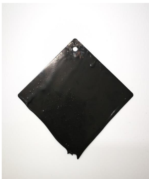
Slika 23. Pločica premazana destilacijskim muljem FP1-210210-1 bez nadorade
