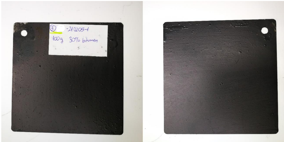
Slika 39. Pločica premazana destilacijskim muljem FP1-210205-1 s dodatkom 30% bitumena
