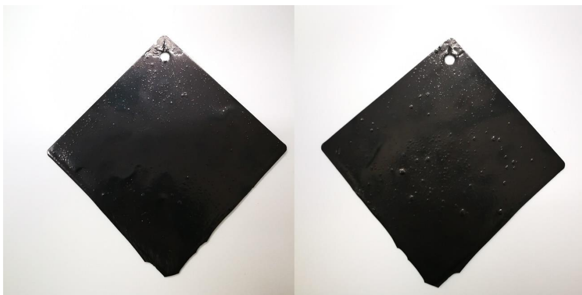
Slika 24. Pločica premazana otpadnim muljem FP1-210210-1 u koji je dodano 5% regenerata
