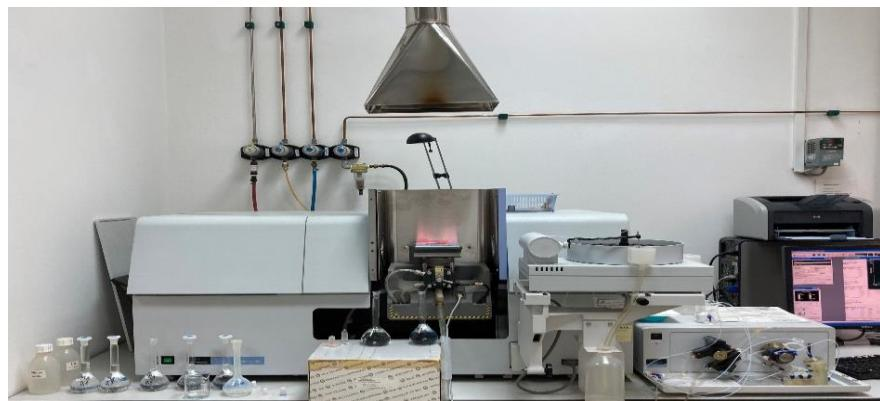
**Slika 15.** Atomski apsorpcijski spektrometar AAnalyst 800
