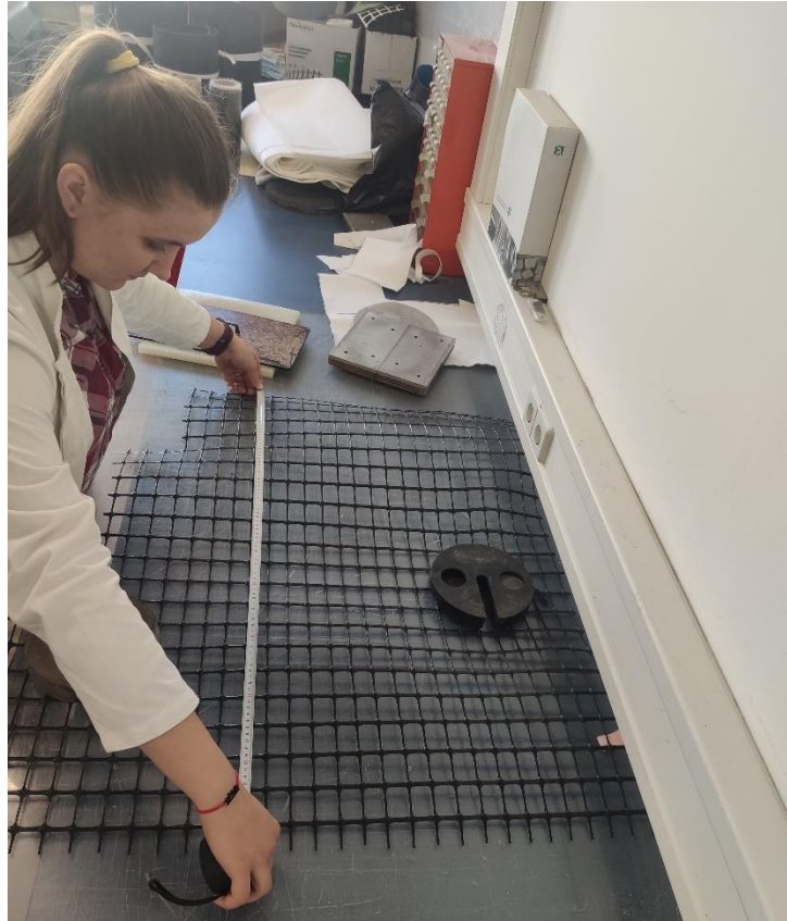
Slika 4. Priprema dvoosne geomreže za ispitivanje vlačnih svojstava
