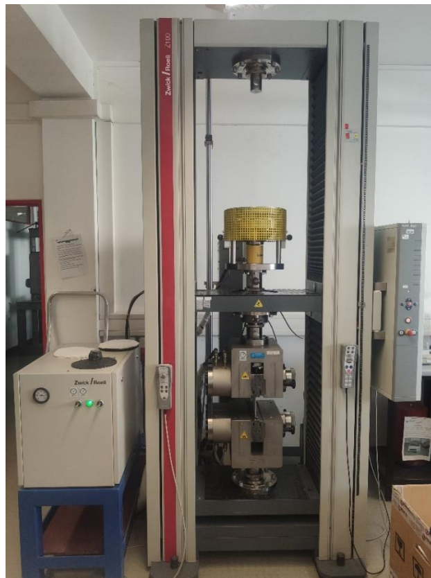
Slika 7. Kidalica proizvođača Zwick/Roell Z100
