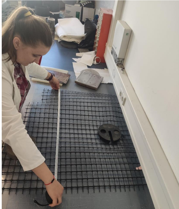
Slika 4. Priprema dvoosne geomreže za ispitivanje vlačnih svojstava
