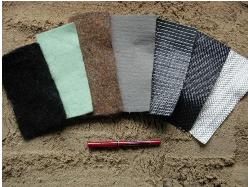
Slika 3. Različite vrste geotekstila [9]
