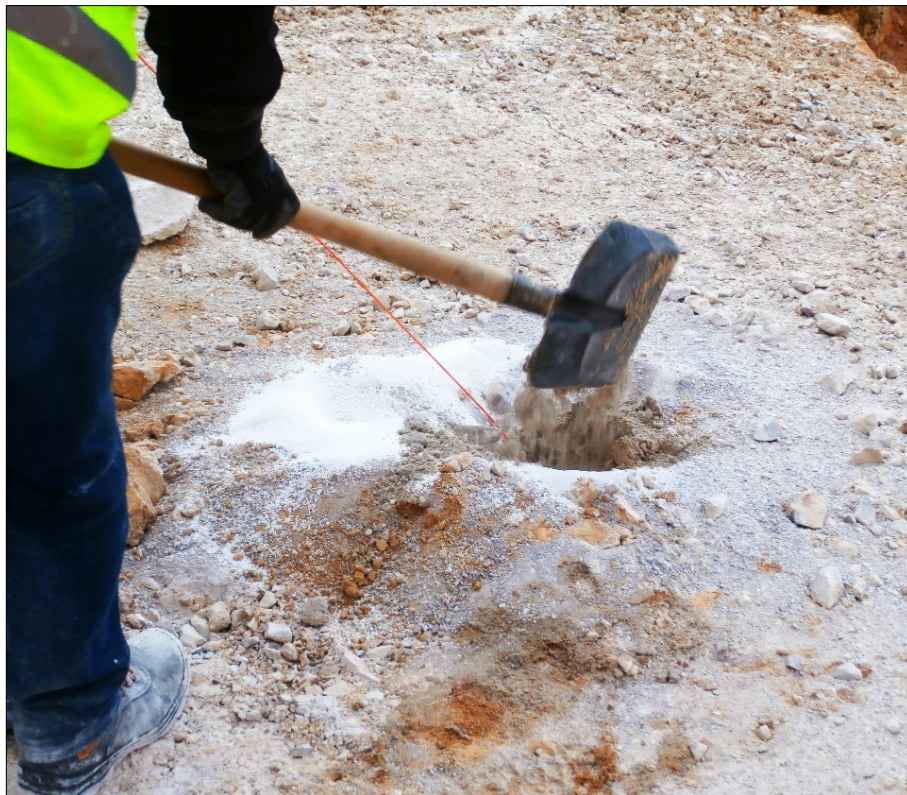
Slika 13. Čepljenje vertikalnih minskih bušotina u kamenolomu „Špica“
