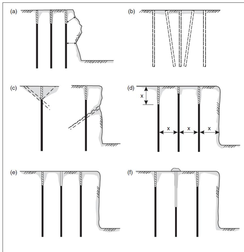
Slika 21. Uobičajeni uzroci razbacivanja komada stijene: (a) neadekvatna izbojница prvog reda; (b) neusklađenost minskih bušotina; (c) pukotine koje odvode plinove eksplozije do slobodne površine; (d) bušotine previše napunjene i prekratak čep; (e) minske bušotine bez izvedenog čapljenja; (f) blokirane (zarušene) bušotine, a ipak napunjene određenom količinom eksploziva (prerađeno prema [13])
