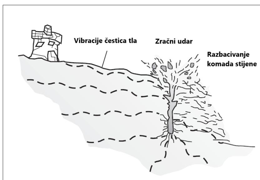
Slika 16. Uzroci oštećenja od miniranja (prerađeno prema [13])
