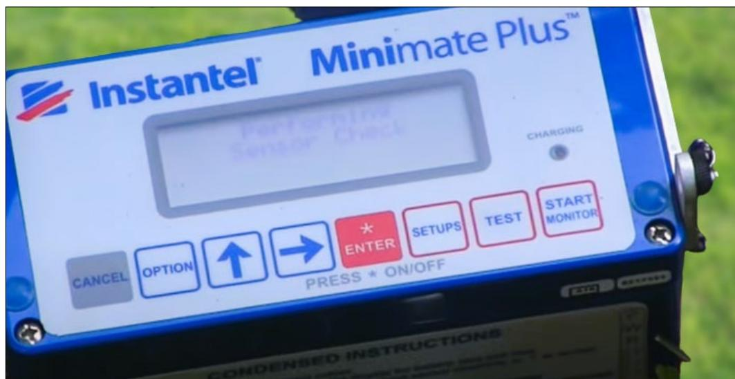
Slika 29. Mjerni uređaj Instantel Minimate Plus
