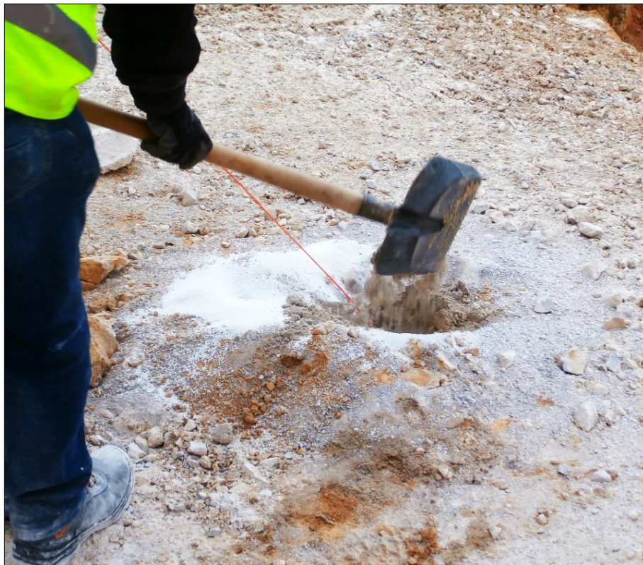
Slika 13. Čepljenje vertikalnih minskih bušotina u kamenolomu „Špica“
