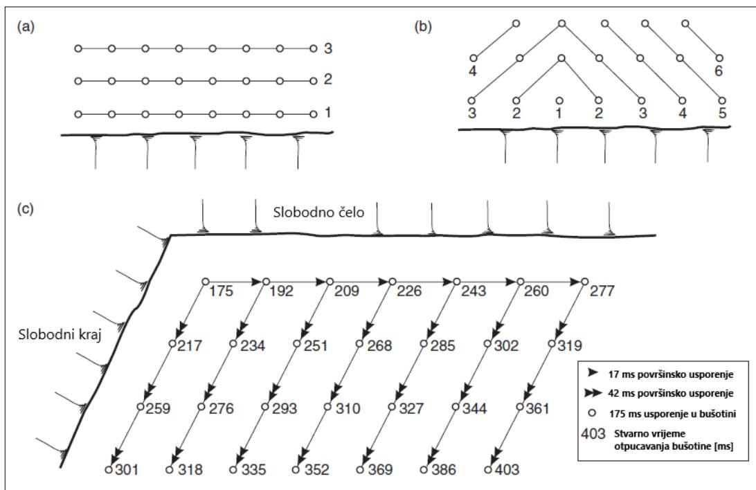
Slika 15. Redoslijedi detonacije: (a) kvadratni redoslijed detonacije "red po red"; (b) uglat "V" redoslijed detonacije; (c) milisekundno otpucavanje minskih bušotina
