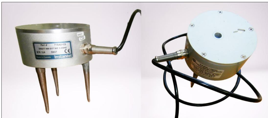
Slika 27. Trokomponentni geofon
