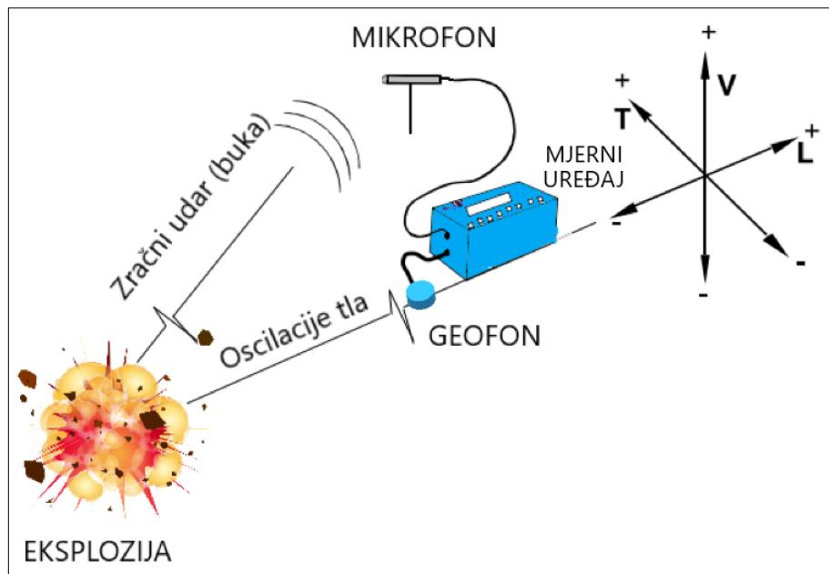
Slika 19. Shematski prikaz mjerjenja zračnog udara i oscilacija tla
