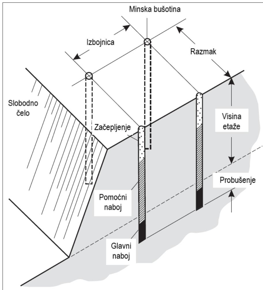
Slika 6. Veličine ili parametri etažnog miniranja (prerađeno prema [13])
