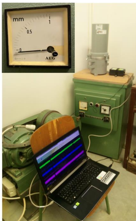
Slika 55. Sustav za određivanje suhe gustoće
