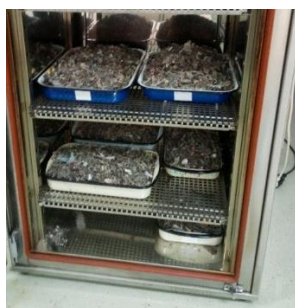
Slika 22. Pripremljeni uzorci metanogene frakcije za određivanje vlažnosti: a) u posudama; b) u sušioniku
