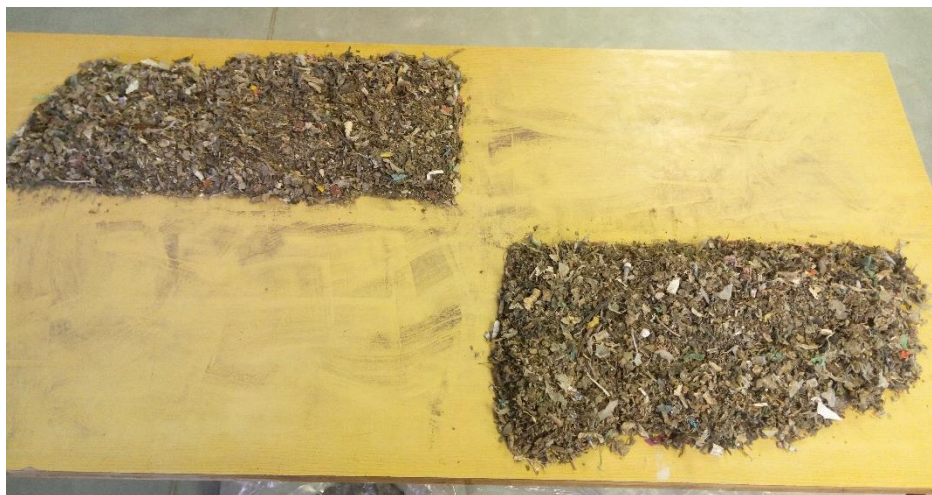
Slika 24. a) Metoda četvrtanja; b) Odbacivanje dvije nasuprotne četvrtine
