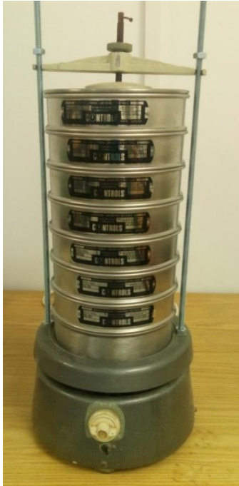
Slika 18. Uređaj za vibriranje i set sita korišteni za određivanje granulometrijske krivulje ispitivanog materijala
