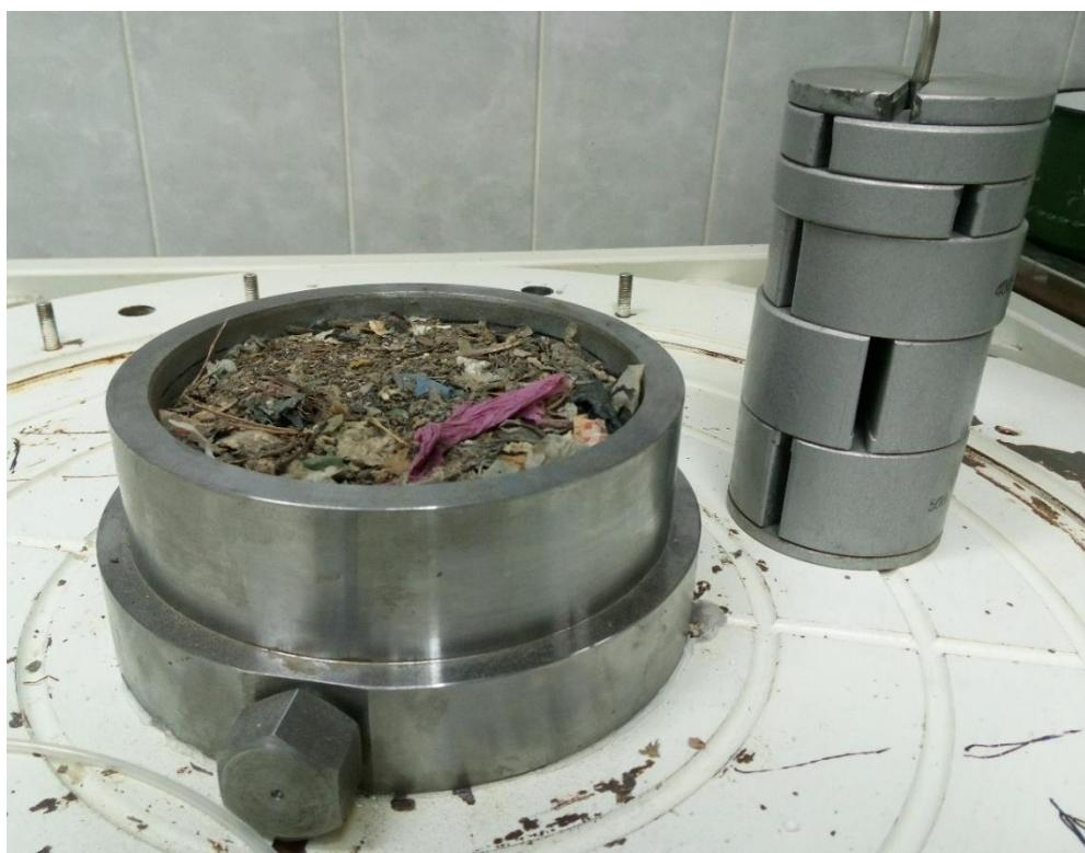
Slika 82. Suhi uzorak ugrađen u čeliju edometra i uteg koji se koristio za ugradnju uzorka u tri sloja
