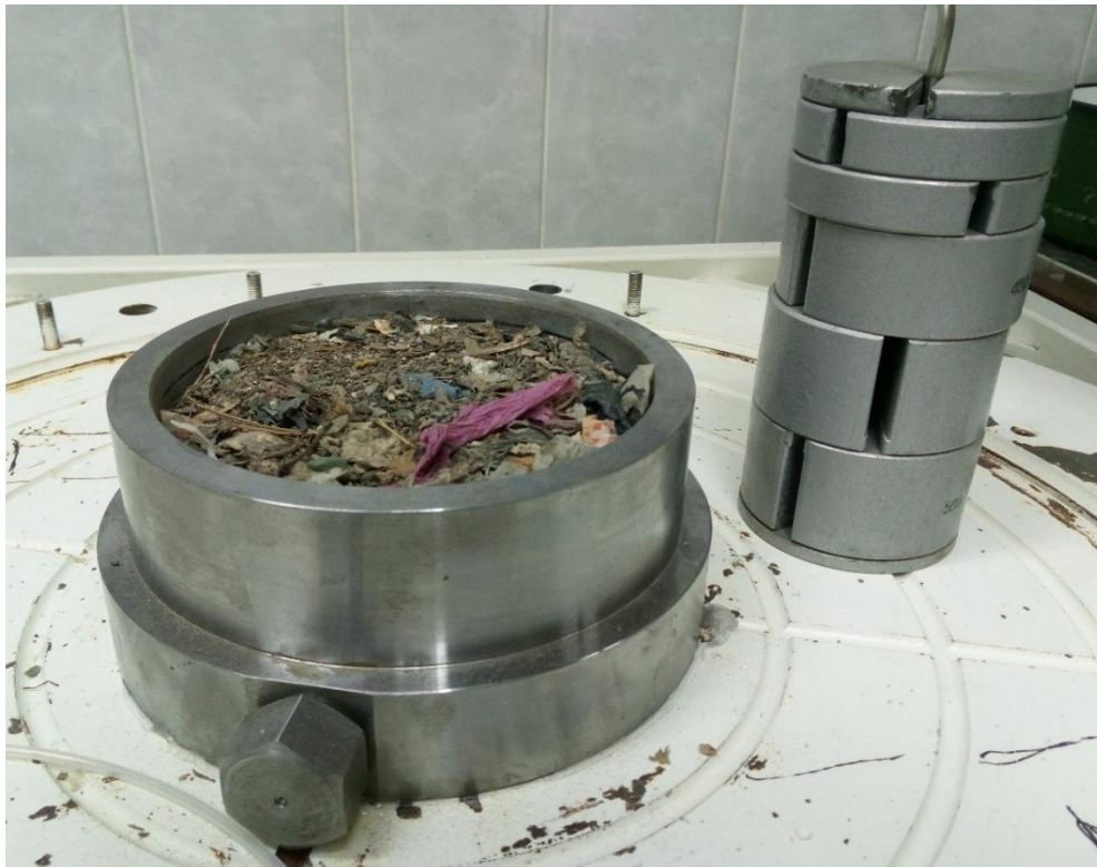
Slika 82. Suhi uzorak ugrađen u ćeliju edometra i uteg koji se koristio za ugradnju uzorka u tri sloja
