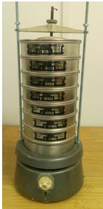
Slika 18. Uređaj za vibriranje i set sita korišteni za određivanje granulometrijske krivulje
