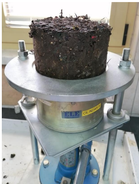
Slika 59. Uzorak bioosušenog otpada prilikom vađenja iz kalupa, materijal B, uzorak s 80% vlage
