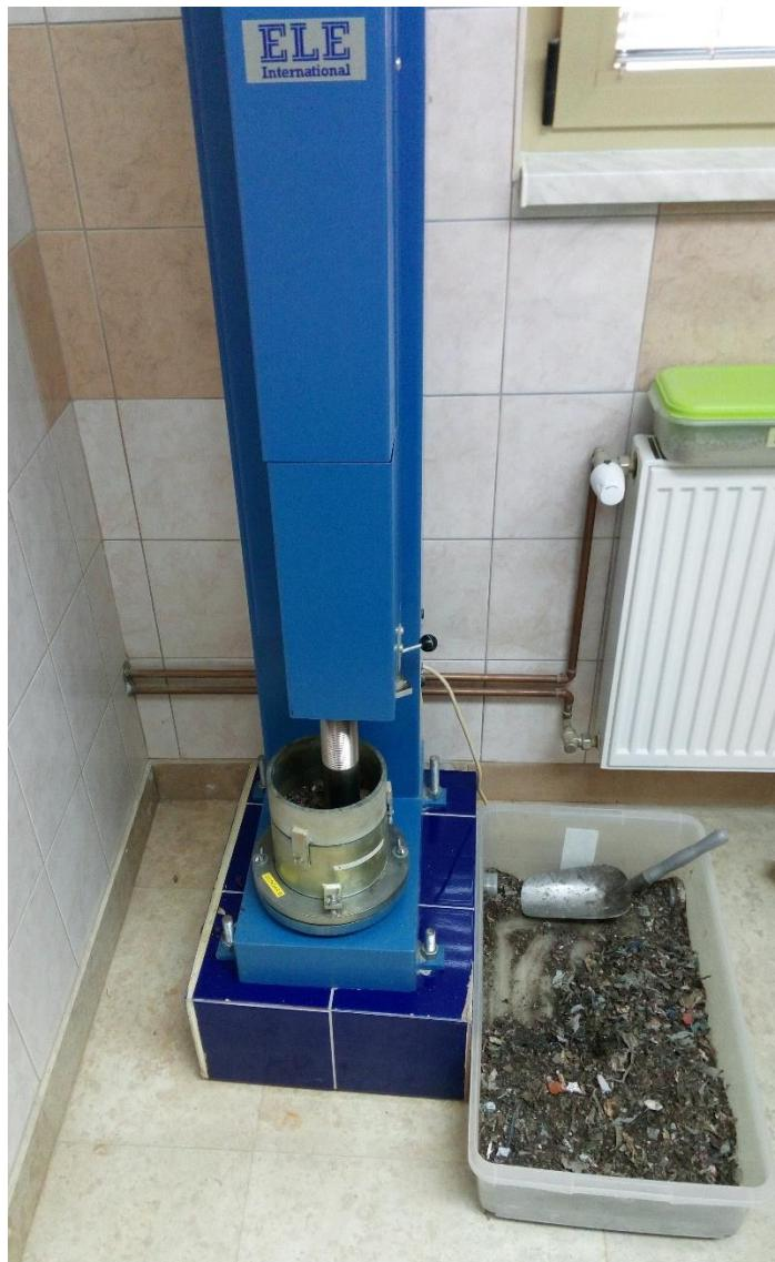
Slika 58. Sustav za ispitivanje standardnim Proctorovim pokusom i metanogena frakcija otpada
