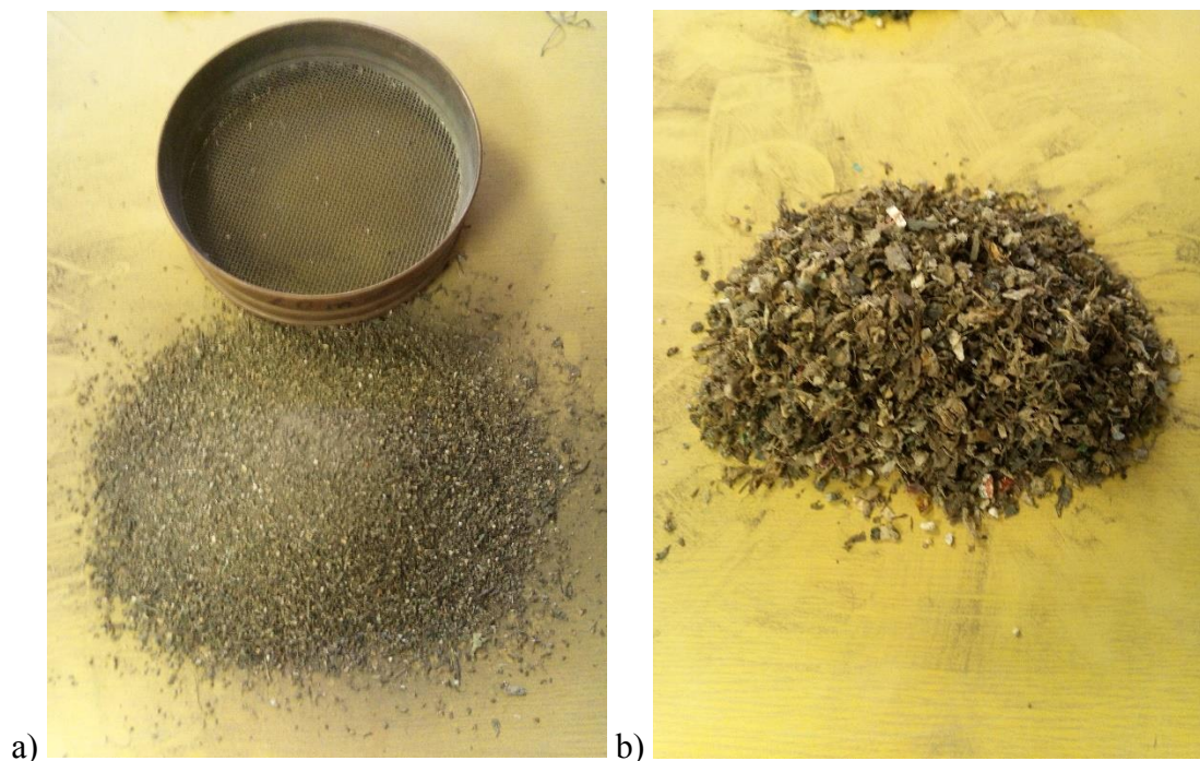
Slika 29. Neidentificirana komponenta uzorka A1 prosijana na situ otvora 2 mm a) frakcija < 2 mm; b) frakcija > 2 mm (0D)
