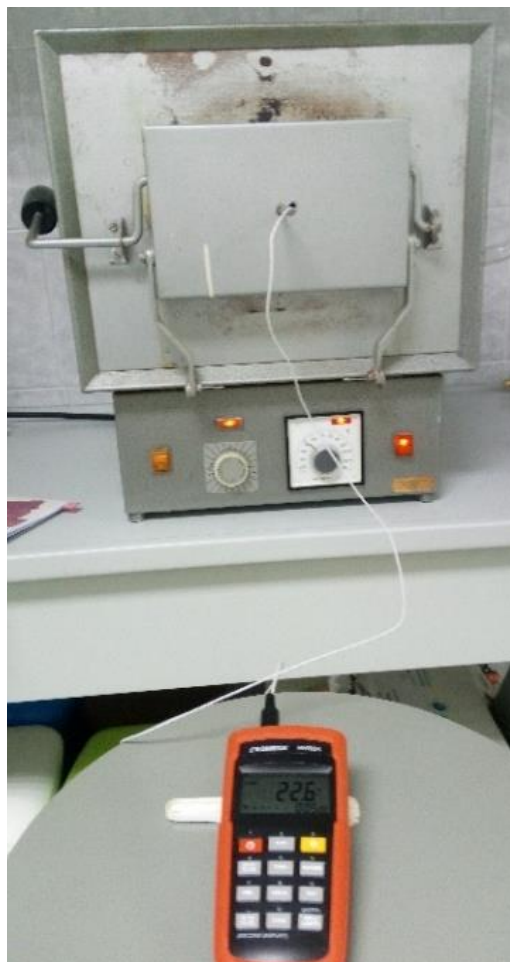
Slika 19. Mjerenje temperature u središtu peći za žarenje temperaturnom sondom
