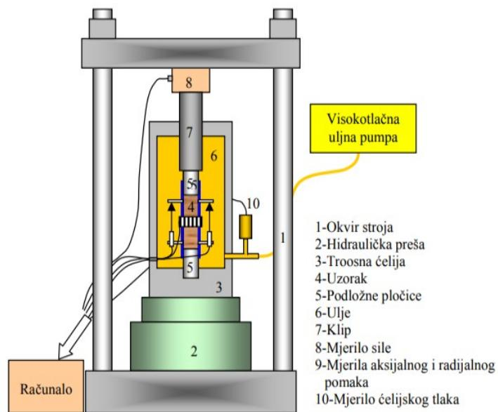
Slika 18. Shematski prikaz opreme za troosna ispitivanja stijena [13]
