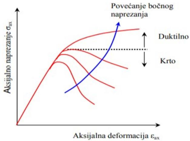
Slika 17. Kompletna naponsko-deformacijska krivulja pri troosnom tlaku [13]
