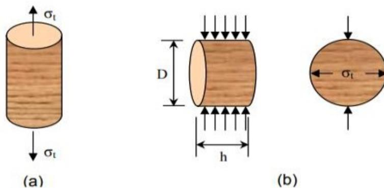
Slika 19. Direktan (a) i indirekstan (b) način ispitivanja vlačne čvrstoće [13]
