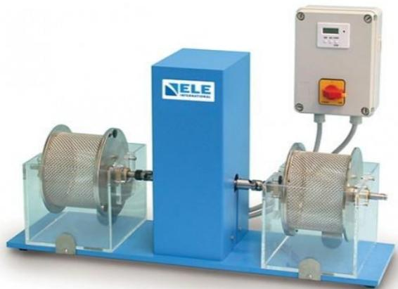
**Slika 20. Uređaj za ispitivanje trajnosti stijene [22]**
