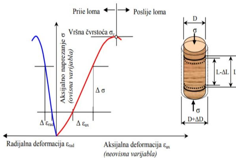
Slika 15. Kompletan naponsko-deformacijski graf pri jednoosnom tlaku [13]
