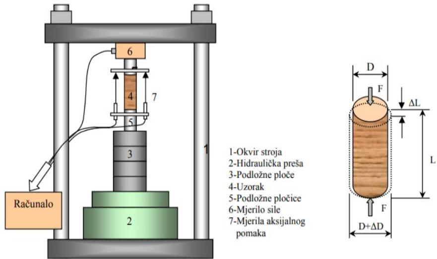
Slika 16. Shematski prikaz opreme za jednoosno ispitivanje stijena [13]
