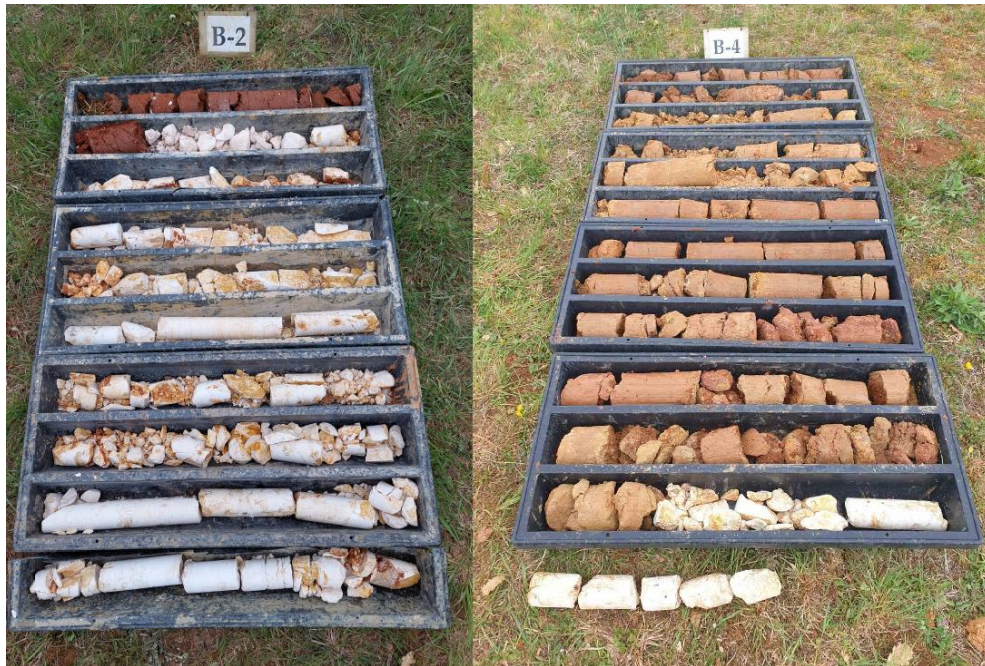
Slika 19. Fotodokumentacija istražne bušotine B-2 (0-10 m) i istražne bušotine B-4 (0-12 m)
