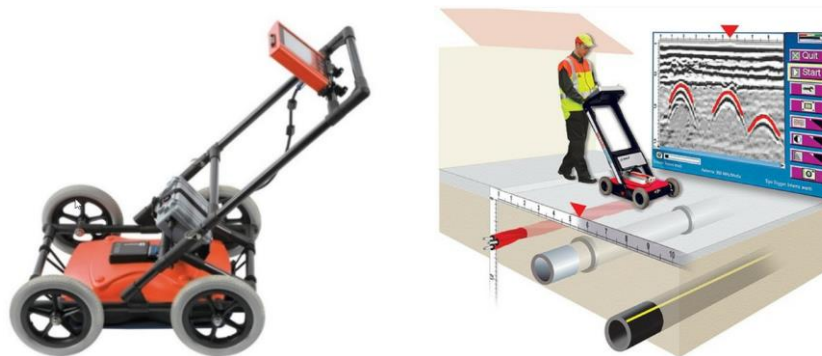
Slika 14. Georadar i princip istraživanja metodom georadara [15]
