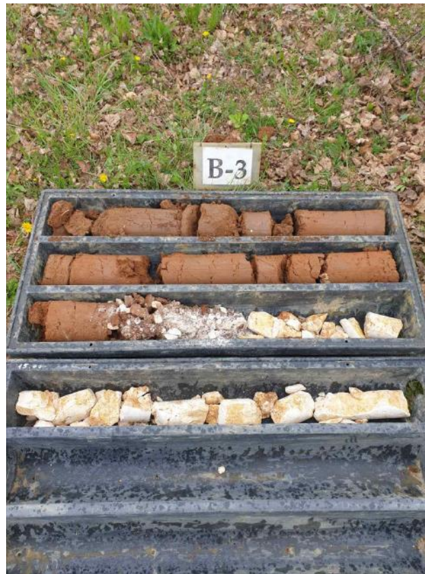
Slika 6. Fotodokumentacija istražne bušotine B-3 (0-4 m) za potrebe temeljenja trgovačkog centra u Pazinu
