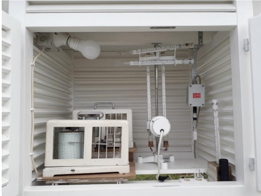
Slika 3. Prikaz unutrašnjosti termometrijske kućice [12]
