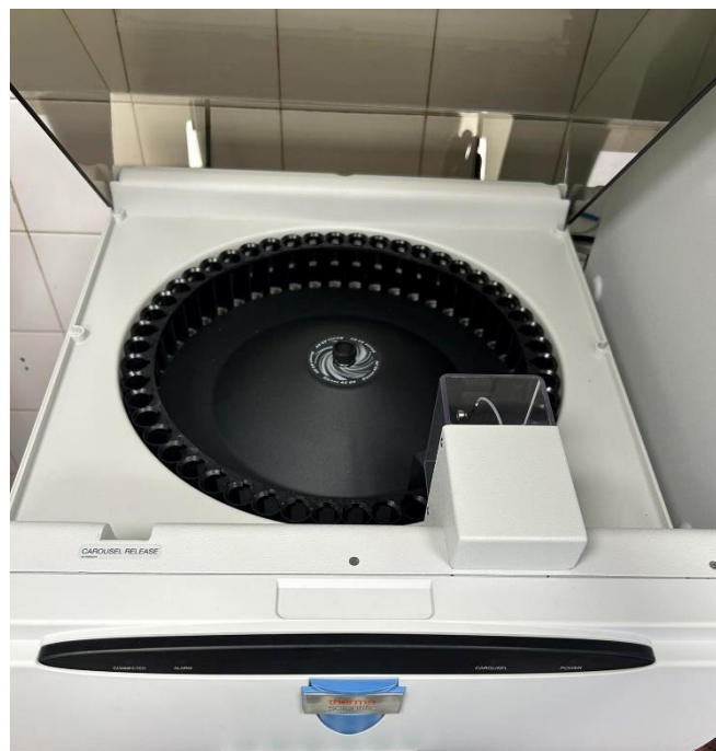
Slika 19. Autosampler (dio ionskog kromatografa)
