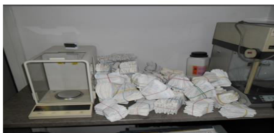
Slika 20. Laboratorijska obrada dnevnik uzoraka filter papira s mjernih postaja, sušenje uzoraka u laboratoriju DHMZ-a [31]
