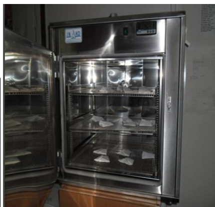
Slika 20. Laboratorijska obrada dnevnik uzoraka filter papira s mjernih postaja, sušenje uzoraka u laboratoriju DHMZ-a [31]
