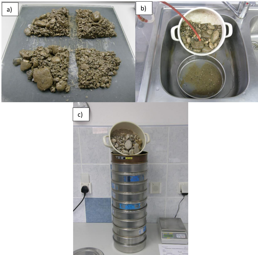
Slika 32. Postupak granulometrijske analize zrna nanosa većih od 0,063 mm: A) Četvrtanje uzorka B) ispiranje uzorka C) Tresilica za sisanje uzorka
