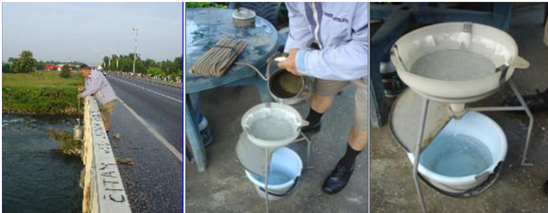
Slika 19. Uzorkovanje vode za analizu suspendiranog nanosa [31]
