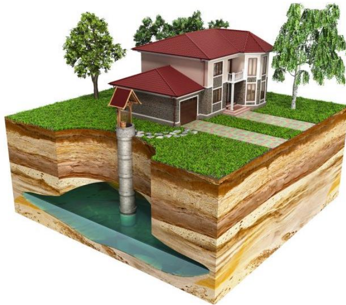
Slika 1 - Crpljenje podzemne vode iz vodonosnika pomoću zdenaca za potrebe kućanstva [5]
