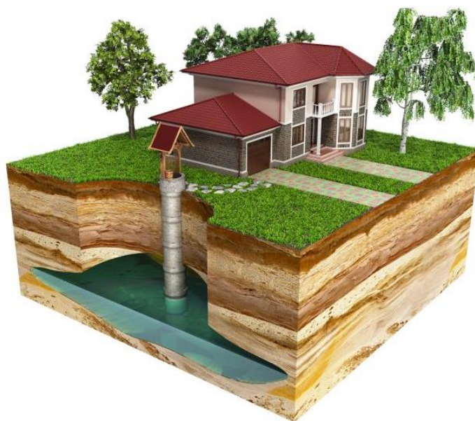
Slika 1 - Crpljenje podzemne vode iz vodonosnika pomoću zdenaca za potrebe kućanstva [5]
