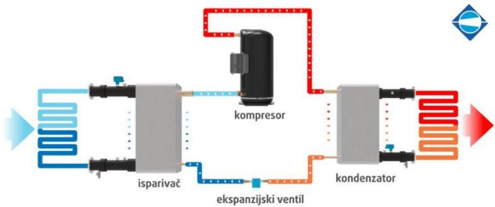
*Slika 27 Princip rada dizalice topline zrak-voda [20]*
