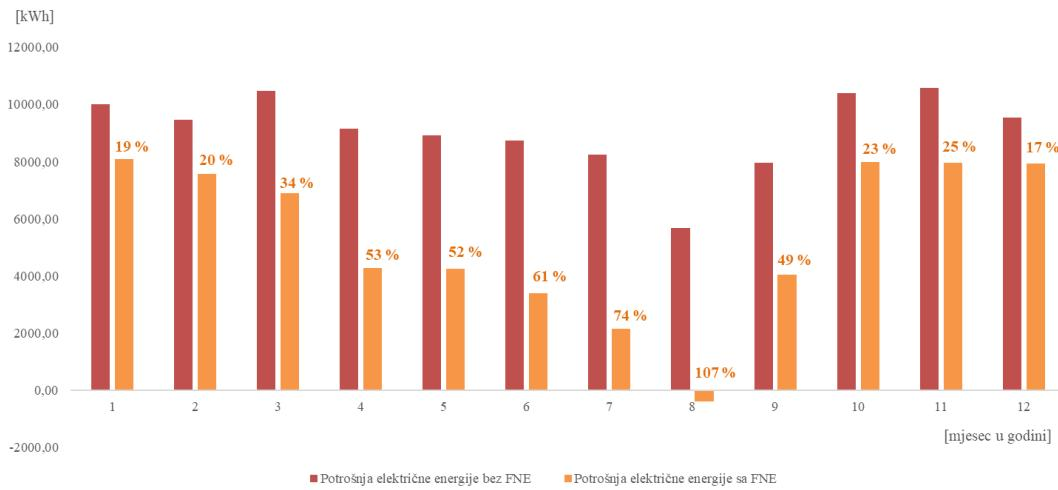
Slika 20 Graf potrošnje električne energije iz mreže bez i sa fotonaponskom elektranom uz prikaz postotaka smanjenja potrošnje za 12 mjeseci
