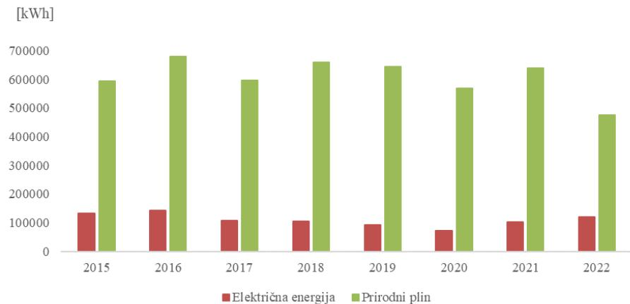
Slika 7 Usporedba potrošnje električne energije i prirodnog plina kroz godine izražena u kWh
