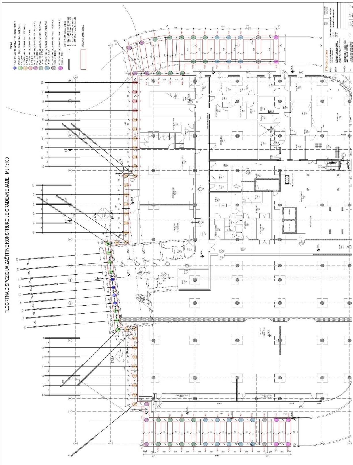
**Slika 14.** Tlocrtna dispozicija zaštitne konstrukcije građevne jame
