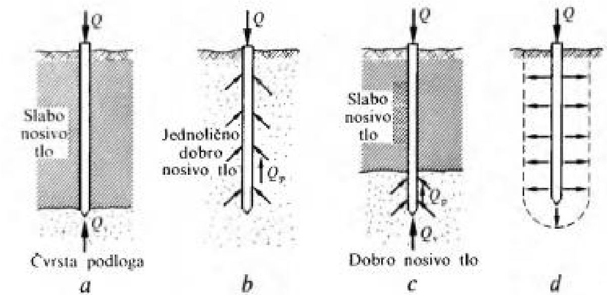
**Slika 6.** Vrste nosivosti pilota [3]
