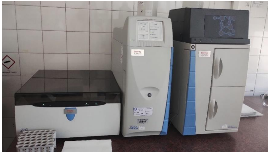
Slika 18. Ionski kromatograf "Thermo Scientific" Dionex Integriion HPIC
