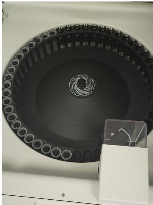
Slika 20. Autosampler na uređaju "Thermo Scientific" Dionex Integrion HPIC
