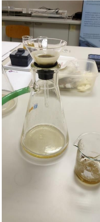
Slika 14 Filtracije obrađene (mljevene) sirove vune nakon adsorpcije
