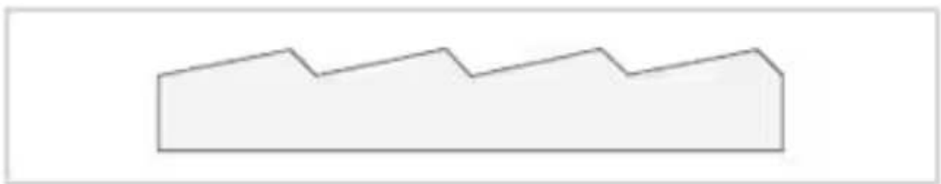
Slika 2. Presjek difrakcijske rešetke (4)
