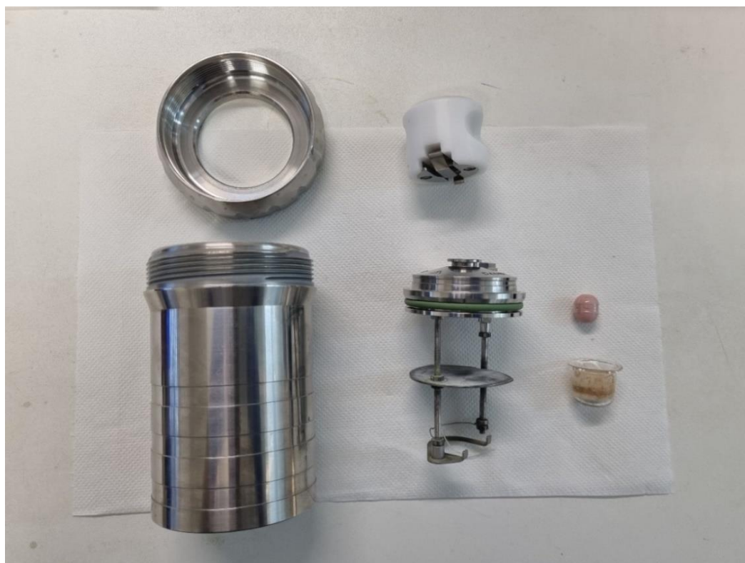
Slika 11. Dijelovi kalorimetrijske bombe
