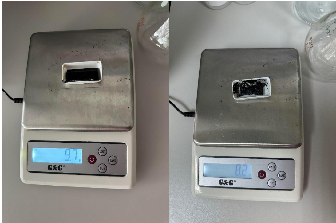
Slika 15: Uzorak 3 prije i nakon zagrijavanja u peći
