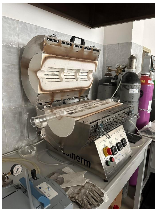
Slika 11: Peć za provedbu vakuumske pirolize
