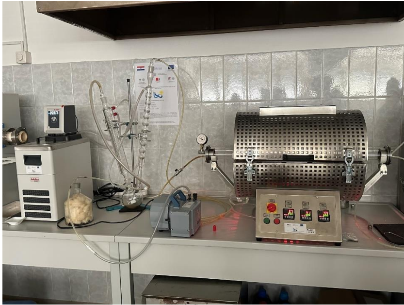
Slika 12: Cijevna peć za žarenje, vakuumska pumpa i uređaj za rashlađivanje plinova
