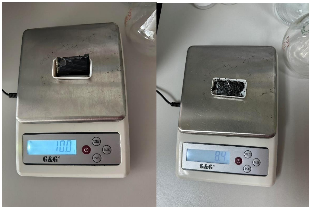
Slika 14: Uzorak 2 prije i nakon zagrijavanja u peći
