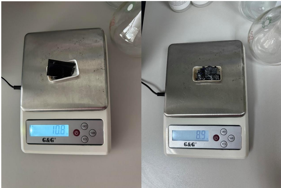
Slika 13: Uzorak 1 prije i nakon zagrijavanja u peći
