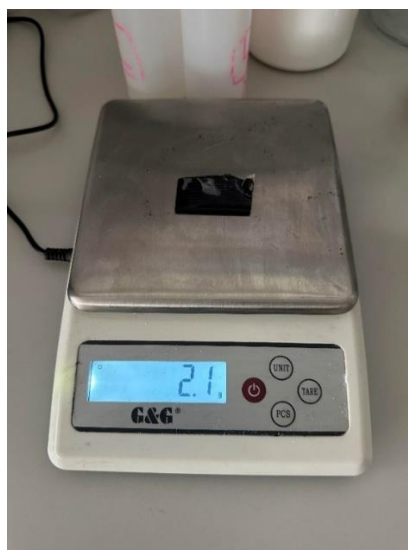
Slika 10: Masa probnog uzorka prije zagrijavanja u peći
