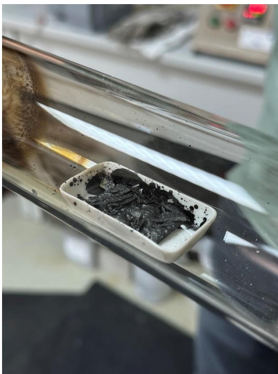
Slika 11: Probni uzorak nakon zagrijavanja u peći
