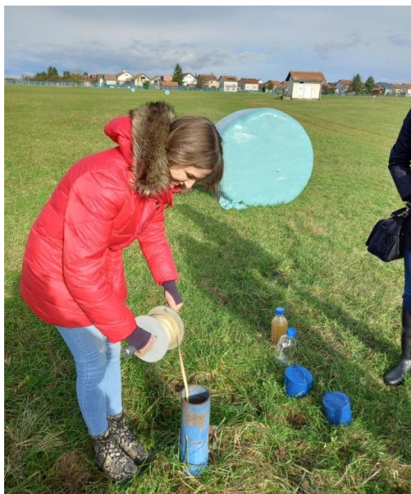
Slika 4. Mjerenje razine podzemne vode na vodocrpilištu Varaždin
