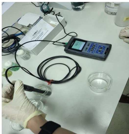
Slika 10. Mjerenje pH i električne vodljivosti
