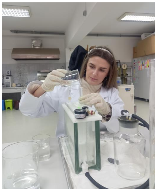
Slika 9. Provođenje ekstrakcija čvrste faze
